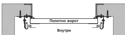
При выполнении несущих строительных конструкций из пустотелых материалов, таких как эффективный кирпич (пустотный керамический и силикатный кирпич) или камни керамические щелевые и силикатные, а также из ячеистых бетонов (газо- и пенобетон, газо- и пеносиликат) и газосиликатных блоков проем рекомендуется оформлять конструкцией из металлического фасонного профиля.
