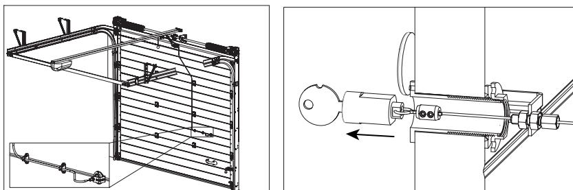
Рис. 6. Механизм разблокировки
